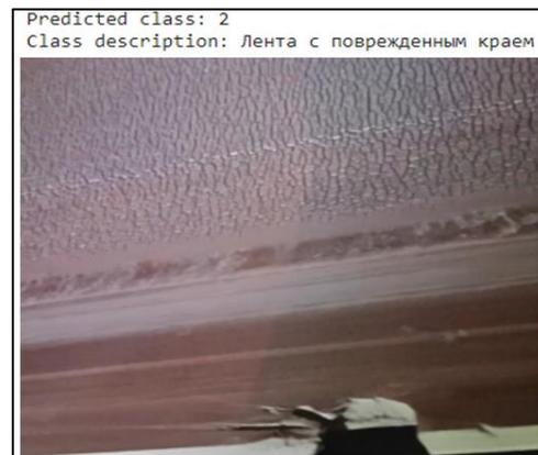
*Рис. 2. Результат работы модели - «Лента с поврежденным краем»*
