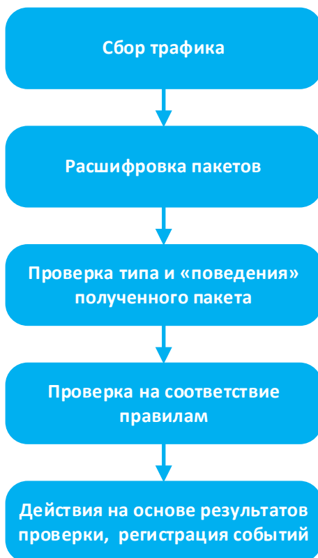
Рис. 1. Архитектура обработки пакетов Snort Fig. 1. Snort's Packet Processing Architecture
