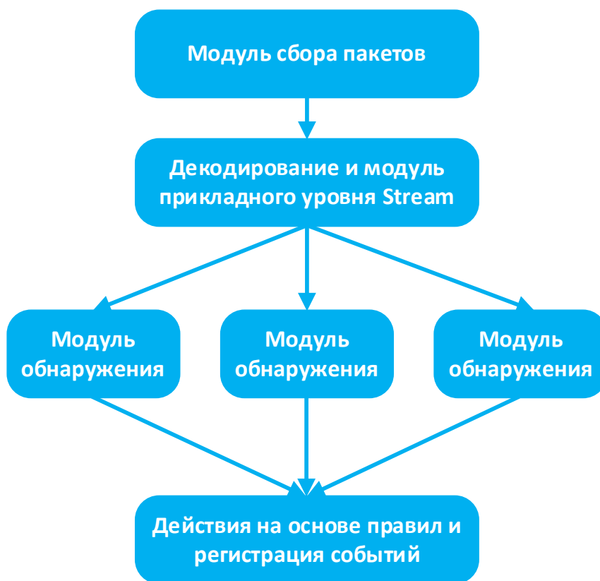
Рис. 2. Многопоточная архитектура обнаружения Suricata
