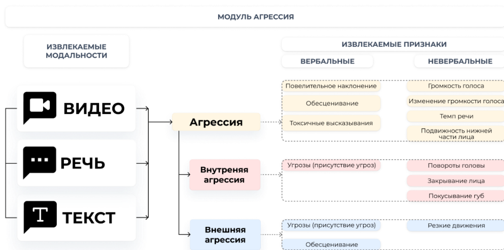
Рис. 2. Перечень извлекаемых признаков модуля агрессии Fig. 2. List of extracted features of the aggression module
