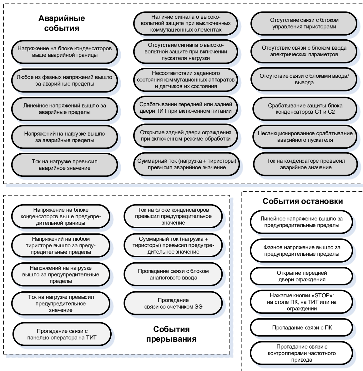
Рис. 6. Условия формирования событий контроллера Fig. 6. Conditions for generating controller events
