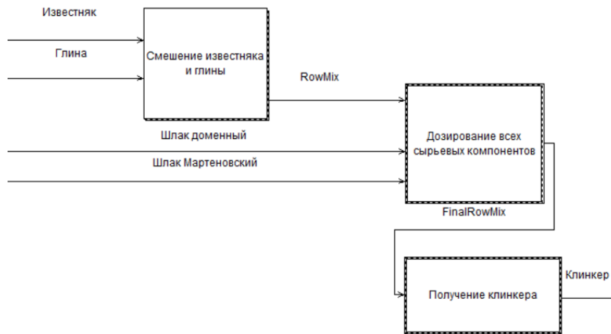
Рис. 1. Графоаналитическая модель преобразования сырьевых компонентов в клинкер Fig. 1. Graphic-analytical model of conversion of raw materials into clinker
