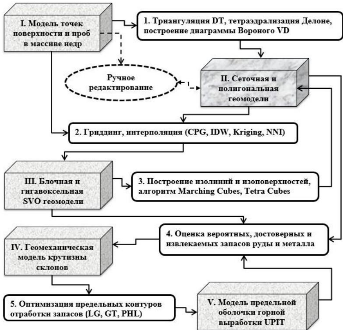
Рис. 1. Общая схема основных моделей и методов оценки извлекаемых запасов руды Fig. 1. General scheme of the basic models and evaluation methods recoverable ore
