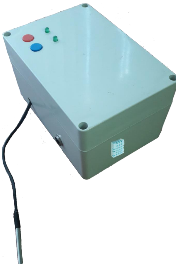
Рис. 3. Внешний вид исполнительного модуля подсистемы отопления Fig. 3. External view of the heating subsystem executive module
