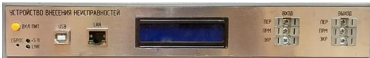
Рис. 1. Внешний вид устройства внесения неисправностей в электрический кабель связи Fig. 1. Appearance of the device for making faults in the electrical communication cable
