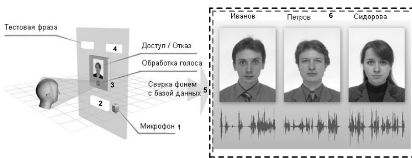
Рис. 6. Алгоритм работы системы разграничения доступа по голосу Fig. 6. Algorithm of the system of voice verification access control
