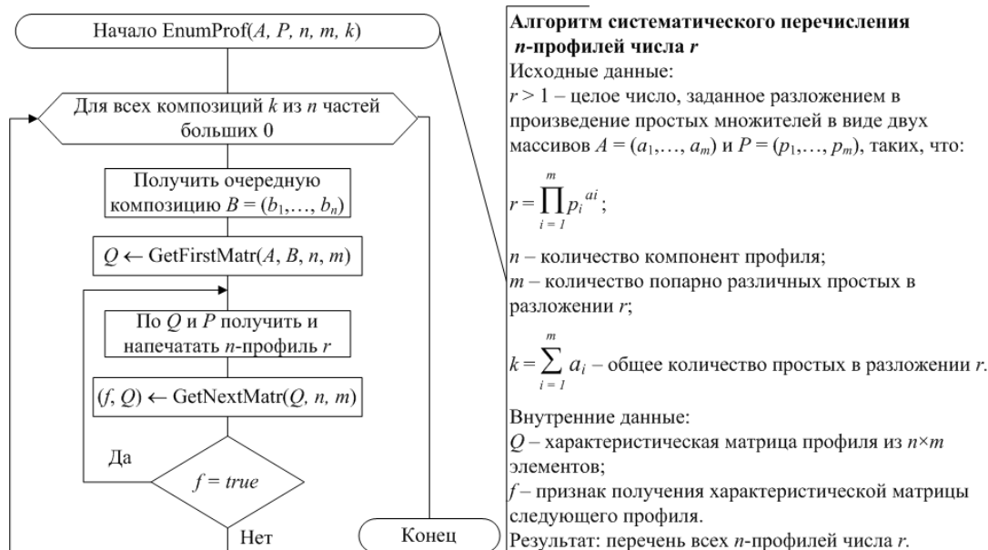
Рис. 1. Блок-схема систематического перечисления n -профилей числа r Fig. 1. Flowchart for the systematic enumeration of n -profiles of the number r
