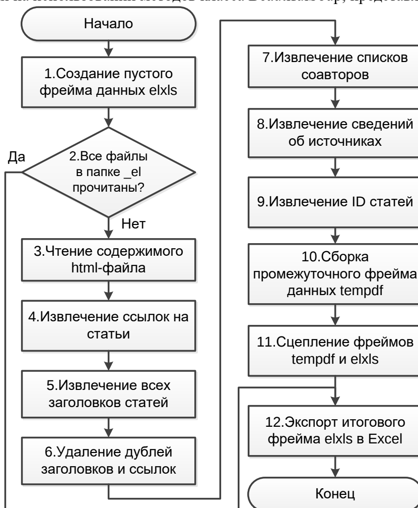
Рис. 5. Блок-схема общего алгоритма программы для синтаксического офлайн-анализа сохраненных публикационных данных из портала eLIBRARY.RU
