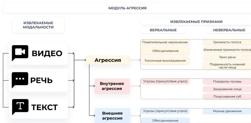
Рис. 2. Перечень извлекаемых признаков модуля агрессии
