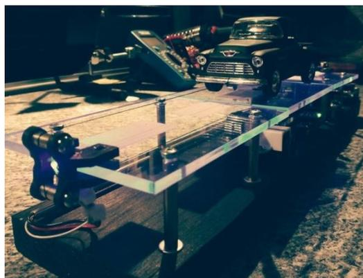
Рис. 1. Стенд для изучения методов измерения скорости и массы автомобилей на дорогах
