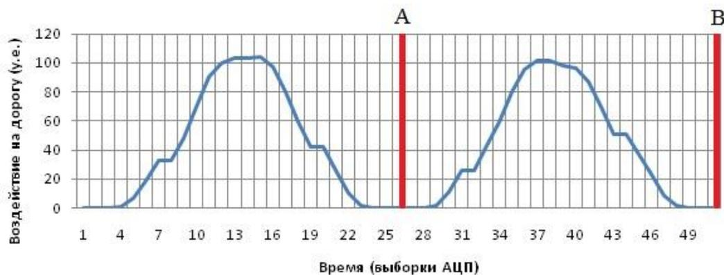
Рис.3. График зависимости давления на секцию модели дороги от времени
