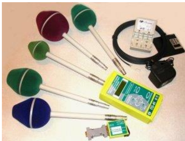
Рис. 2. Измеритель уровня электромагнитного излучения ПЗ-41
